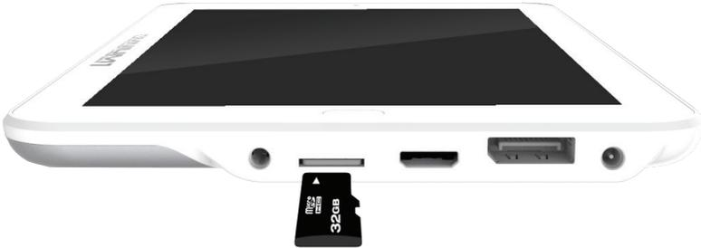
Setzen Sie eine Mikro SD-Speicherkarte (max. 32 GB) in den Kartenslot wie auf der Zeichnung auf dem Gerät angegeben. Schieben Sie nicht zu fest und wenden Sie keine Gewalt an. Ein Federwiderstand muss überwunden werden. Die Speicherkarte ist richtig eingesetzt, wenn sie leicht einrastet und nicht von selbst wieder herausgleitet.
